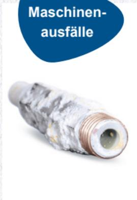
Störungen der Maschinen durch hohen Partikelanteil im Wasser
